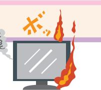
液晶テレビのトランジスタ回路の不良が原因で、漏電によりテレビ台が焼損。完成品メーカーがリコールを実施し、原因となった部品の製造メーカーに対して、損害を一部求償した。
