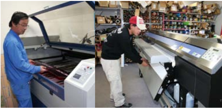
設備も最新の機器が揃っている(レーザー加工機(左)・インクジェットプリンター(右))
