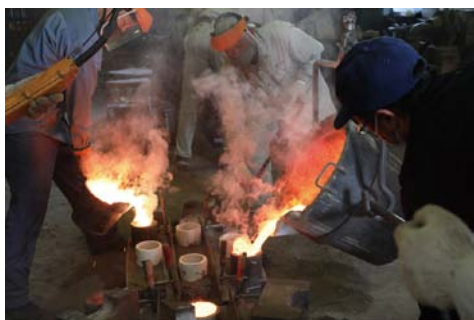
1000℃以上に熱せられた砲金が砂型に注がれる
